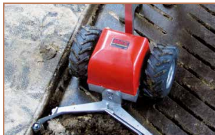
Breite Bereifung - Frostschutz befüllt
