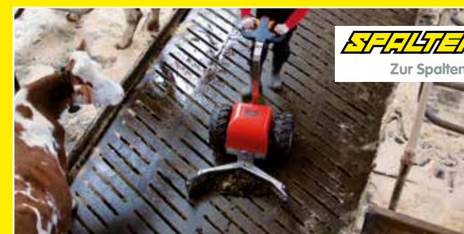
FUTTERSCHIEBER 125cm breites Schiebeschild • 3-fach verstellbar
