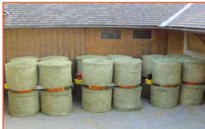
3 Belüftungsmodule für 24 Rundballen
