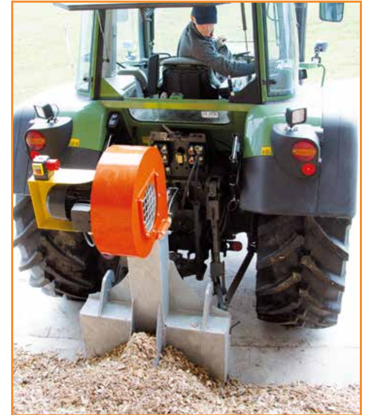
Hochleistungslüfter mit integriertem Schnellwechsler
