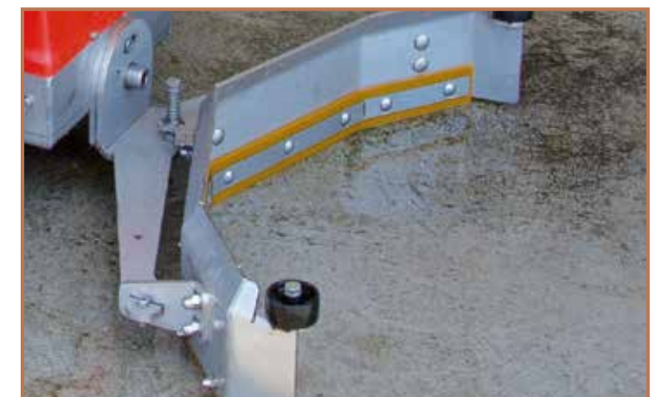
Reinigungsleiste aus Vulkollan (wendbar)
