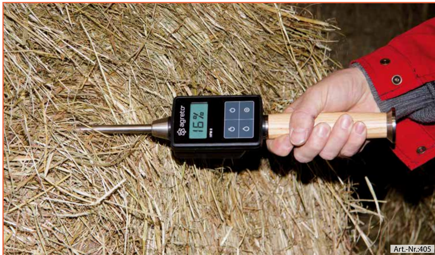
Heufeuchtemesser mit Temperaturkontrolle zur Kontrolle der Lagerfähigkeit
