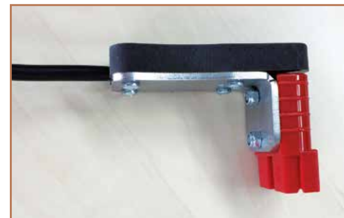
Ladestecker mit Zugentlastung und Griff
