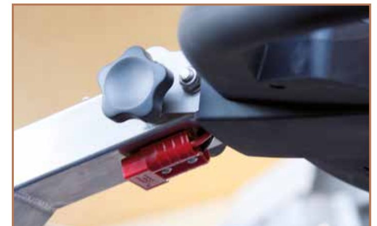
Batterieladestecker geschützt angebracht
