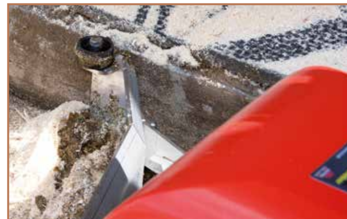
Seitliche Anlaufrollen am Schieber verbaut
