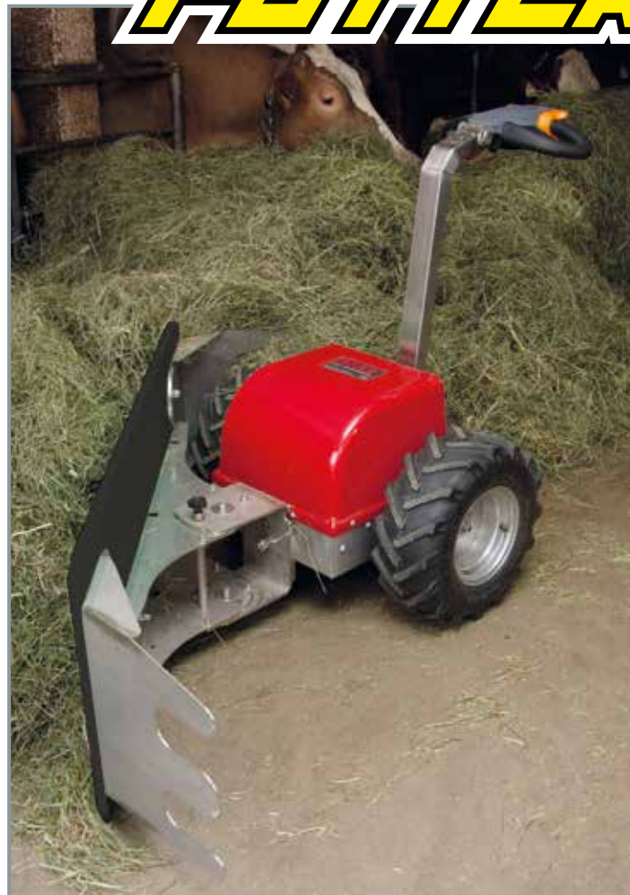
3-fach schwenkbares Schiebeschild
