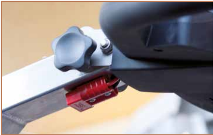
Batterieladestecker geschützt angebracht
