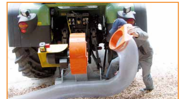
Schlauch mit Schnellwechselanschluss
