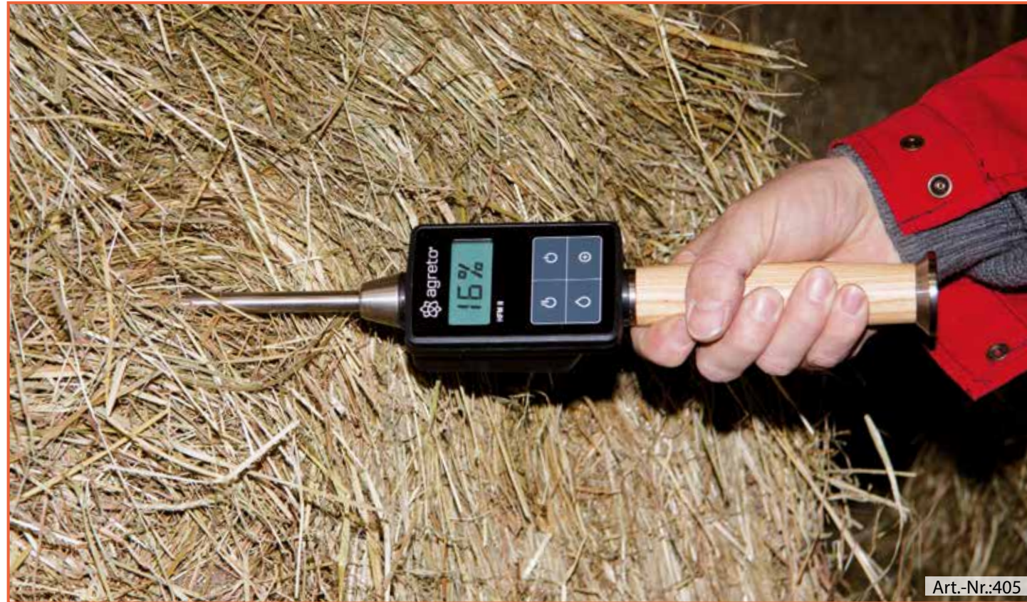
Heufeuchtemesser mit Temperaturkontrolle zur Kontrolle der Lagerfähigkeit
