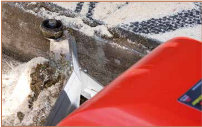
Seitliche Anlaufrollen am Schieber verbaut
