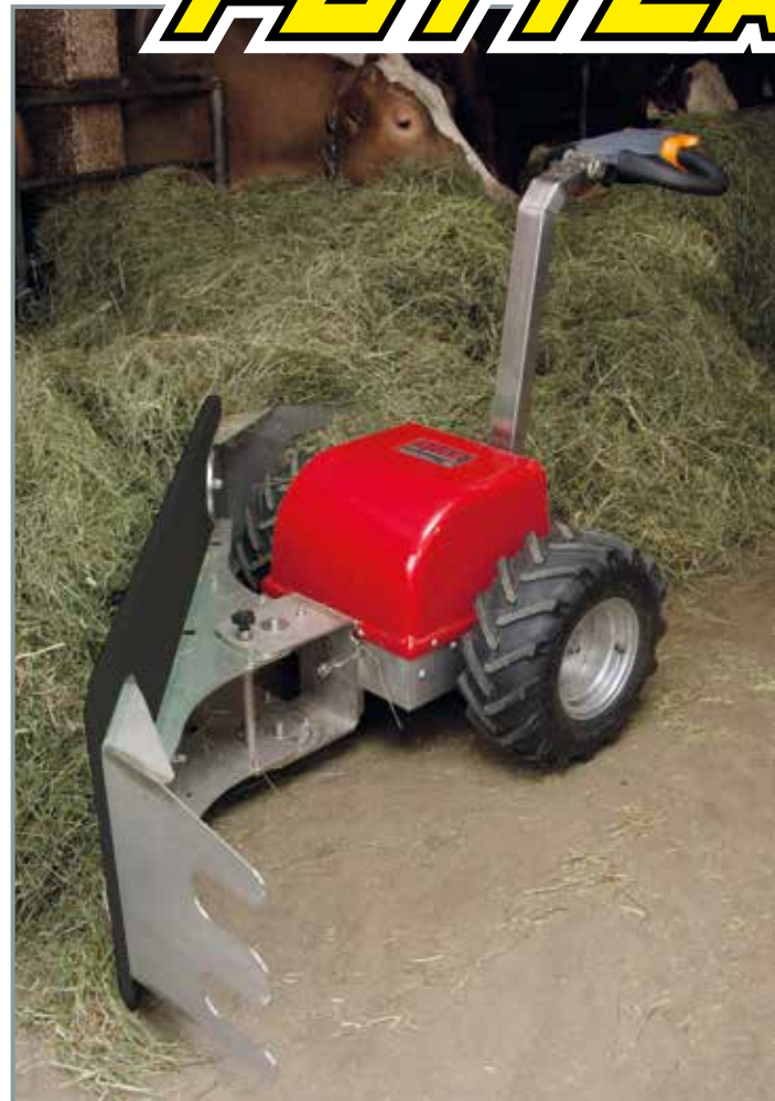
3-fach schwenkbares Schiebeschild
