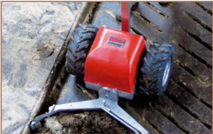
Breite Bereifung - Frostschutz befüllt
